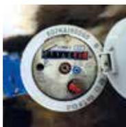
L'index du compteur d'eau est fourni directement en m<sup>3</sup>. Il n'est pas nécessaire de relever les chiffres en rouge.
